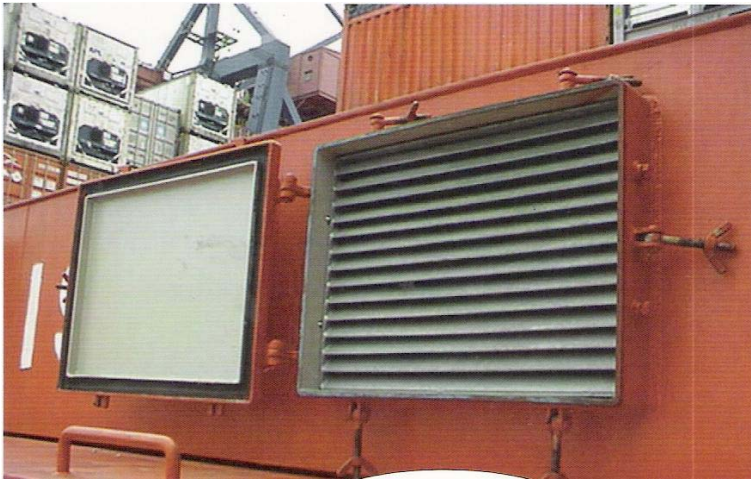
Εικόνα γ34: Vent in good condition
