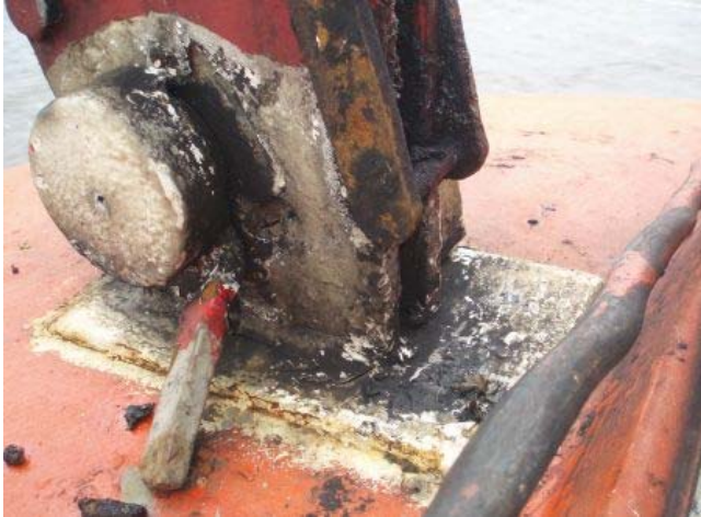
Εικόνα 10: Lifeboat release mechanism defective
