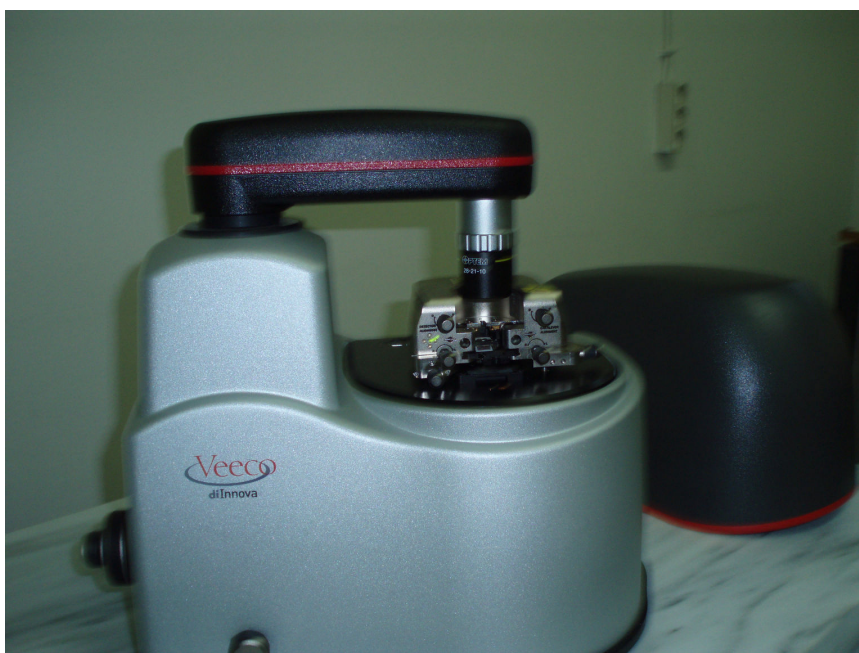
Σχήμα 6.4 Η συσκευή AFM που χρησιμοποιήθηκε για τη μελέτη στα πλαίσια της παρούσας εργασίας.
