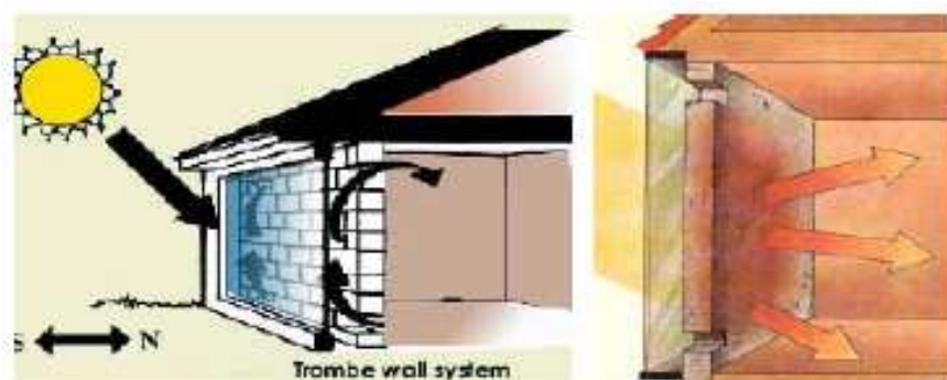
Εικόνα 2.7: Λειτουργία τοίχου TROMBE-MICHEL
