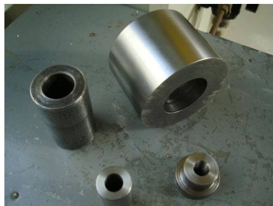
Φωτογραφία 56: Το σύστημα μήτρα-περιοχή αγκίστρωσης
