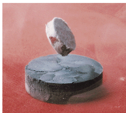
Σχήμα 11: Μαγνητική αιώρηση μαγνήτη πάνω από έναν υπεραγωγό ο οποίος βρίσκεται σε θερμοκρασία μικρότερη της T_c
