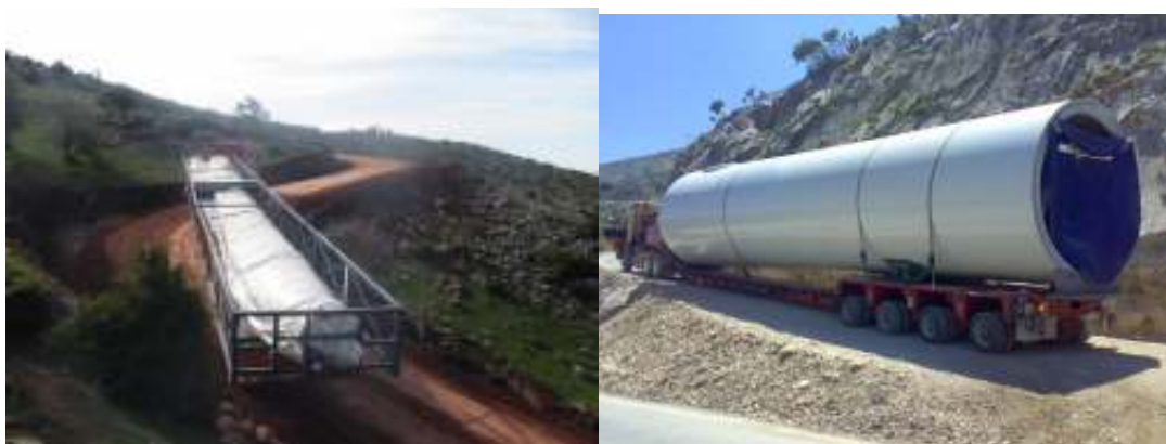
Φωτογραφία 4.2.4. Μεταφορά πτερυγίων και πυλώνων ανεμογεννητριών
