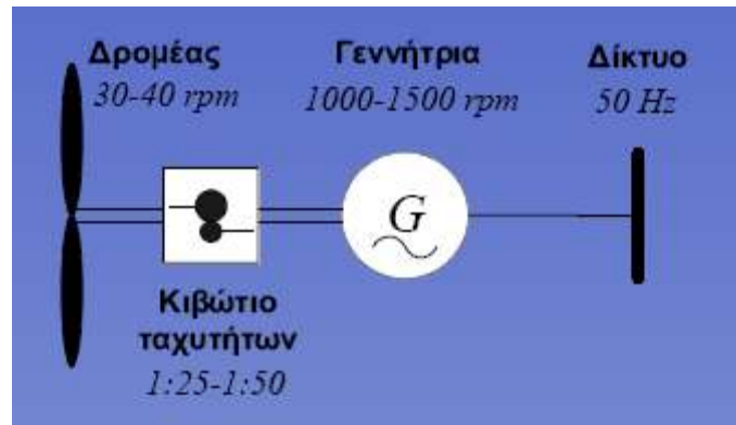
Σχήμα 2.4.7. Σχηματικό διάγραμμα ανεμογεννήτριας σταθερών στροφών
