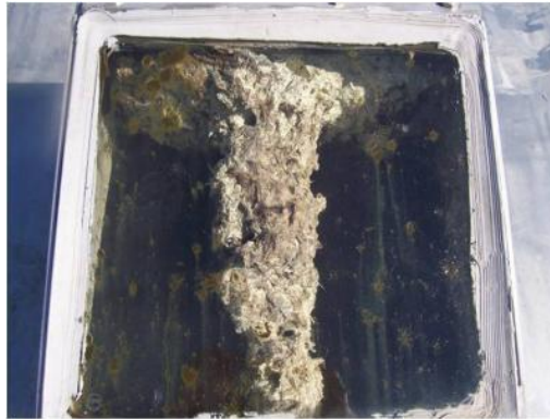
Εικόνα 11.9: Στοιχειακό θείο, που προκύπτει από βιολογική αποθείωση μέσα στο χωνευτήρα [84]
