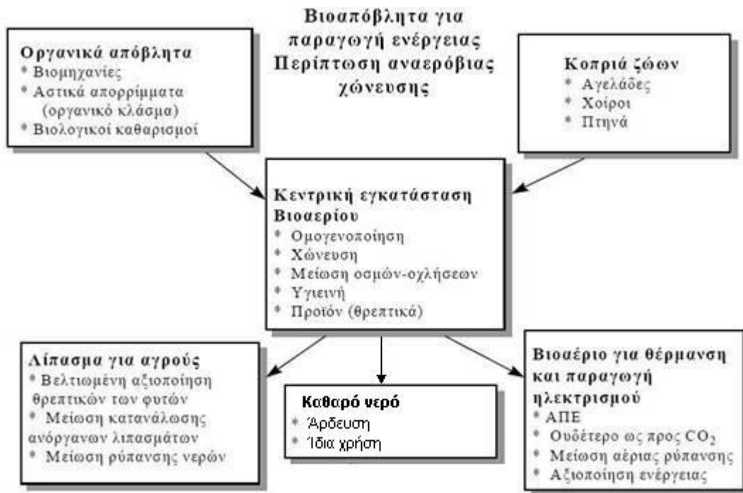
Σχήμα 13.1: Διάγραμμα ροής ολοκληρωμένης επεξεργασίας βιοαποβλήτων[2]
