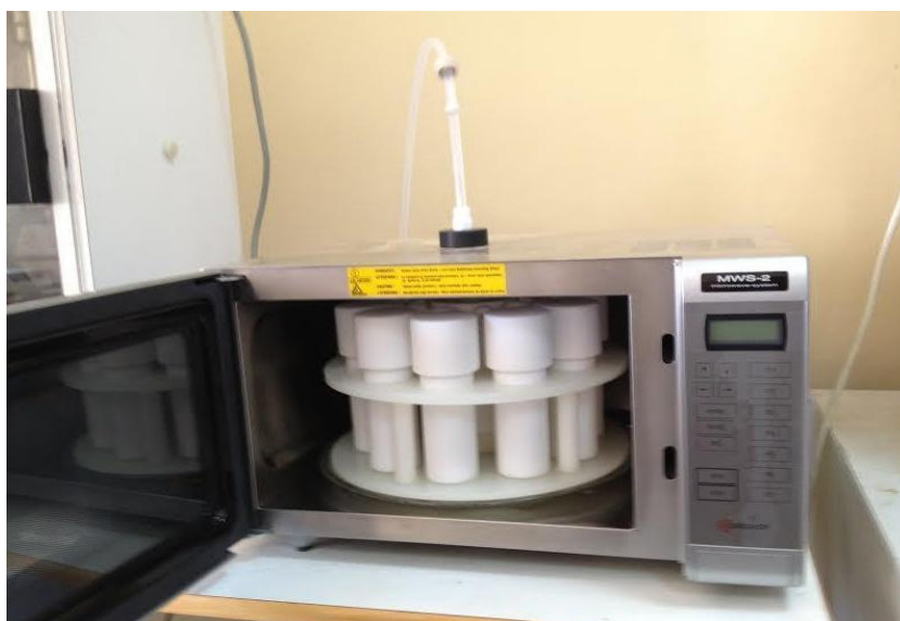
Εικόνα 2-2. Φούρνος μικροκυμάτων (Microwave digestion equipment, speedwave™ MWS-2, Berghof Instruments GmbH, Γερμανία)
