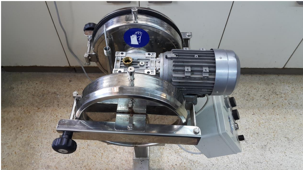
Εικόνα 2-4. Θάλαμος σακχαροποίησης free-fall mixer
