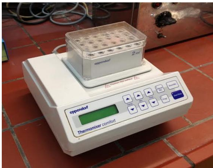
Εικόνα 2-3. Thermomixer (Eppendorf) για τη διεξαγωγή της ενζυμικής υδρόλυσης
