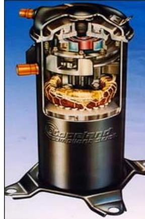
Σχήμα 4.2 : Συμπιεστής τύπου scroll [47].
