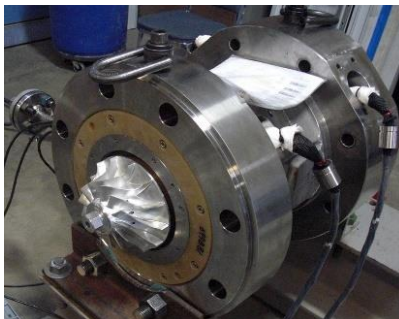
Σχήμα 2.6 : Εκτονωτής δυναμικής ροής ακτινικού τύπου[32].
