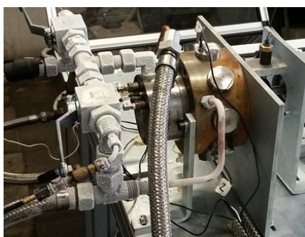
Σχήμα 3.21. Ο 9-κύλινδρος εμβολοφόρος εκτονωτής[39].
