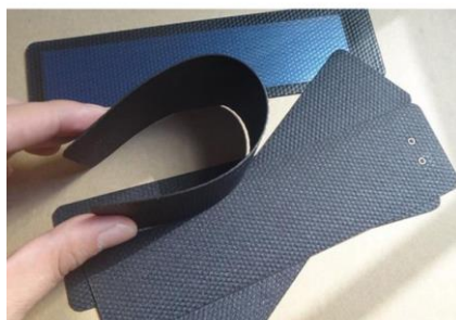
Σχήμα 3-16. Φωτοβολταϊκό σύστημα λεπτού υμενίου άμορφου πυριτίου
