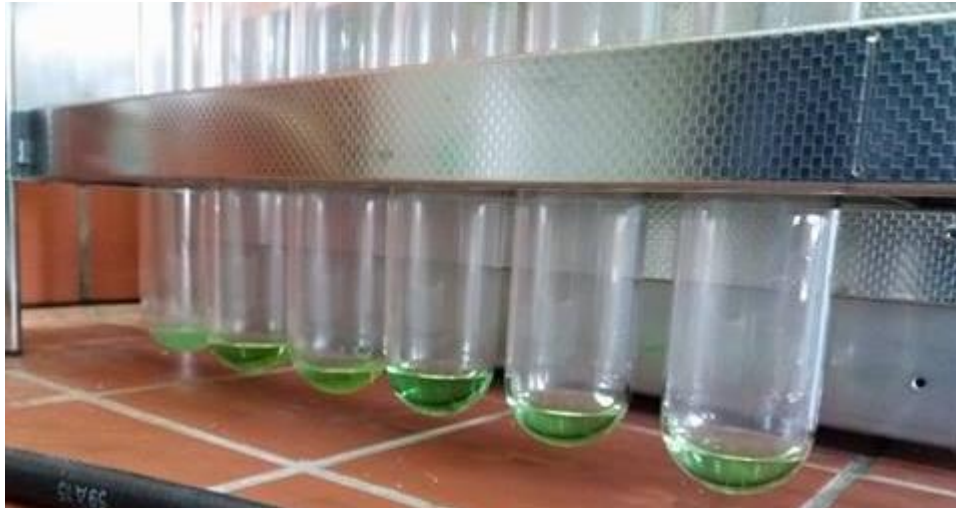
Εικόνα 3.13: Μέτρηση TKN - Σωλήνες αμέσως μετά τη χώνευση
