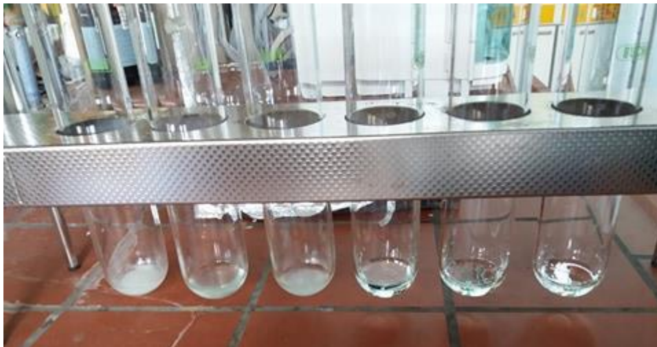
Εικόνα 3.14 : Μέτρηση TKN - Σωλήνες σε θερμοκρασία δωματίου
