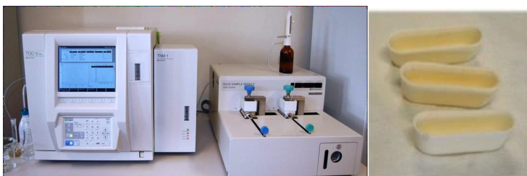
Εικόνα 3.9 : Το σύστημα υπολογισμού ολικού οργανικού άνθρακα TOC και κάψες πορσελάνης όπου εισάχθηκε το δείγμα
