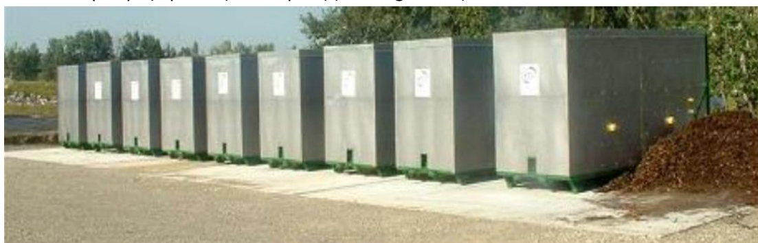
Εικόνα 2.9 : Τυπική διάταξη εγκιβωτισμένων συστημάτων κομποστοποίησης σε παράλληλα στοιχεία
