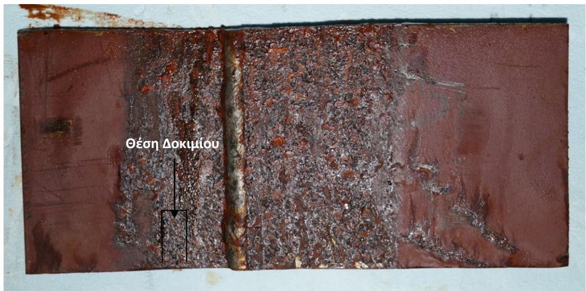
Εικόνα 53 : Θέση δοκιμίου σε περιοχή κοντά στην συγκόλληση.
