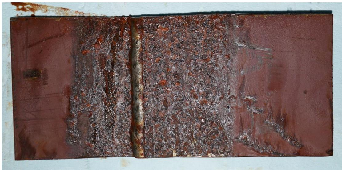
Εικόνα 50 : Έλασμα που έχει υποβληθεί σε δοκιμή αλατονέφωνσης.
