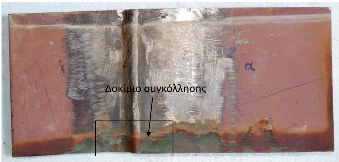
Εικόνα 48: Θέση δοκιμίου στη συγκόλληση
