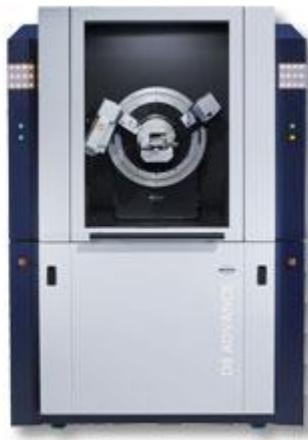
Εικόνα 15 : Όργανο XRD που χρησιμοποιήθηκε για τις μετρήσεις (14)
