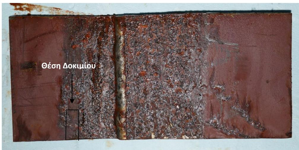
Εικόνα 56 : Θέση δοκιμίου κοντά στην συγκόλληση.
