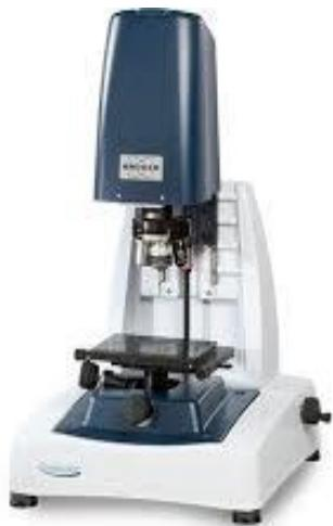
*Εικόνα 17 : Προφιλόμετρο που χρησιμοποιήθηκε για τις μετρήσεις(17)*
