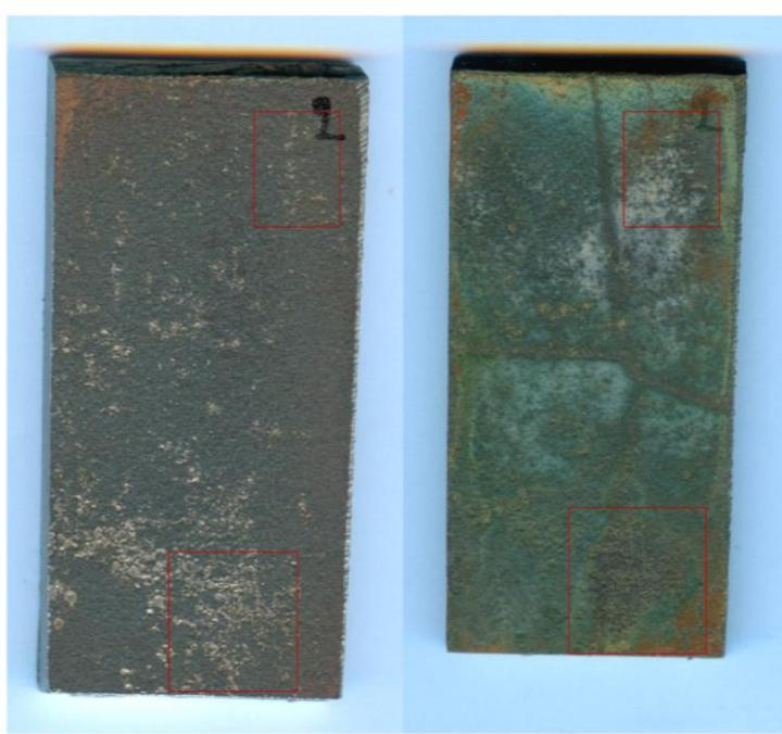
Εικόνα 18: Δοκίμιο πριν την εμβάπτιση (αριστερά) και μετά από έκθεση σε 63 μέρες (δεξιά) με μεγέθυνση
