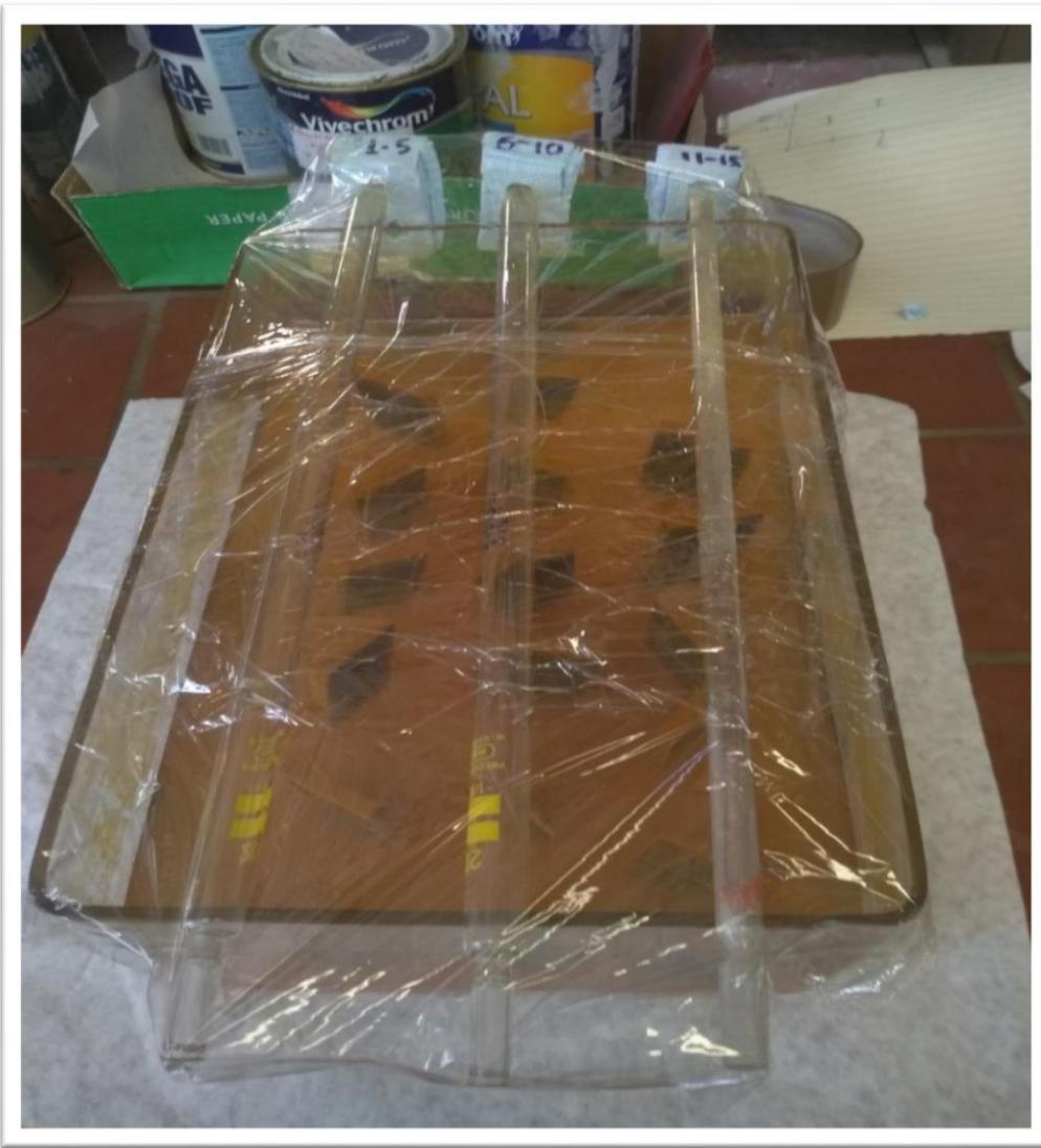
Εικόνα 14 : Διάταξη εμβάπτισης δοκιμίων
