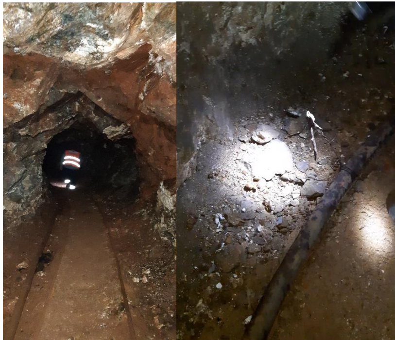
Εικόνα 6.10: Σιδηροτροχιές για την κίνηση μεταλλευτικών κάδων και αγωγός αέρα για τη χρήση μηχανημάτων αέρος
