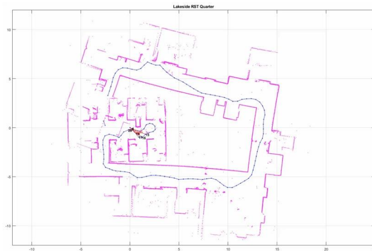
Εικόνα 4.4: Παράδειγμα προβλήματος στο κλείσιμο βρόχου ( https://nl.mathworks.com/discovery/slam.html )
