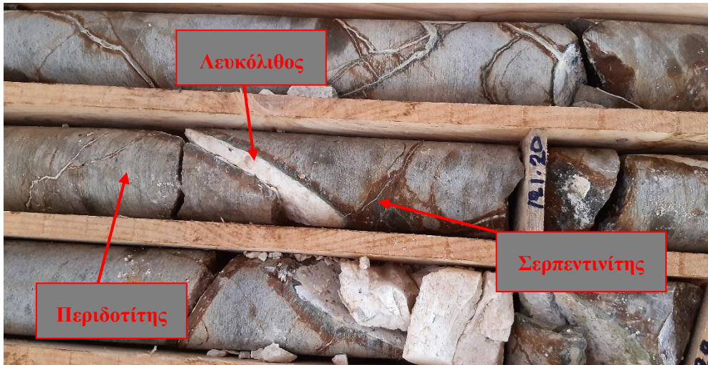
Εικόνα 5.7: Διάκριση περιδοτίτη, σερπεντινίτη και λευκόλιθου σε καρότο ερευνητικής γεώτρησης στην περιοχή του Πηλίου (Προσωπικό αρχείο)
