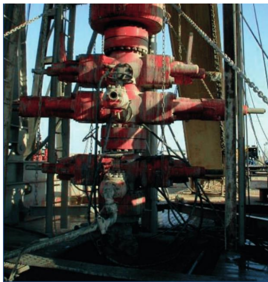
Εικόνα 4-5 Τυπική διάταξη αντιεκρηκτικού μηχανισμού (B.O.P.) (Potter, 2018)
