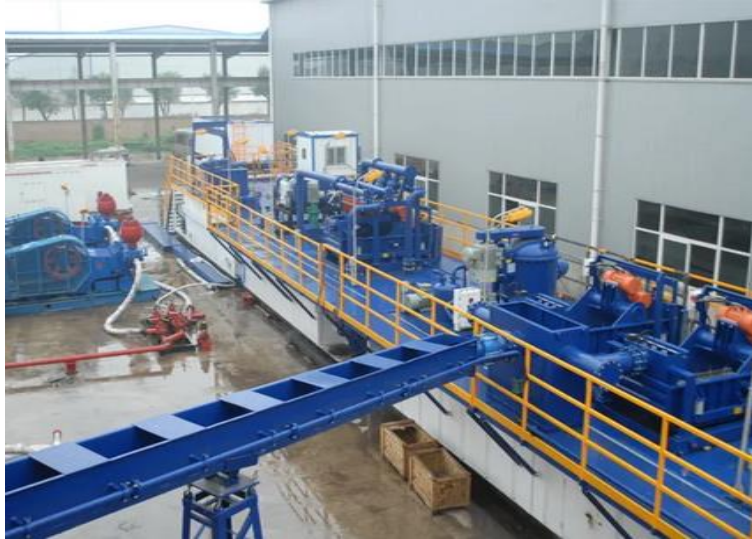
Εικόνα 4-4 Σύστημα καθαρισμού του ρευστού διάτρησης από τα παραγόμενα θρύμματα κατά την όρυξη γεώτρησης
