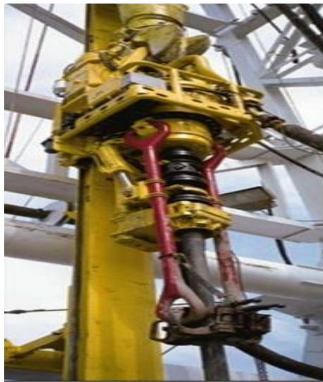
Εικόνα 3-3. Σύστημα περιστρεφόμενης κεφαλής - Top drive (Finger & Blankenship, 2010)
