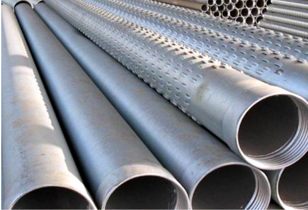
Εικόνα 6-12. Τυφλή σωλήνωση και φιλτροσωλήνες υδρογεωτρήσεων (Κανέλλος, 2014)
