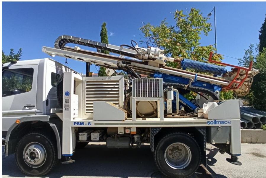
Εικόνα 6-6 Αυτοκινούμενο τροχοφόρο γεωτρύπανο με ονομασία PSM – 8 της εταιρείας Soilmech, το οποίο έχει αξιοποιηθεί από το ΕΑΓΜΕ για την όρυξη υδρογεωτρήσεων.
