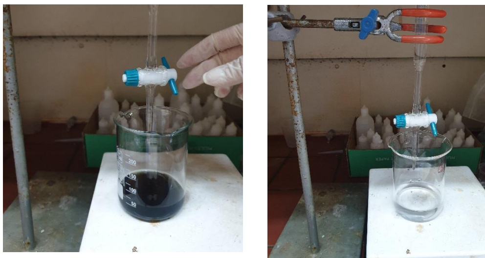
Σχήμα 5.4 : Μετατροπή μπλε διαλύματος σε διαφανές, τέλος τιτλοδότησης
