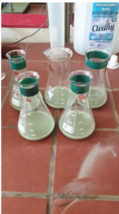
Σχήμα 5.2 : Προετοιμασία πολφού στο εργαστήριο
