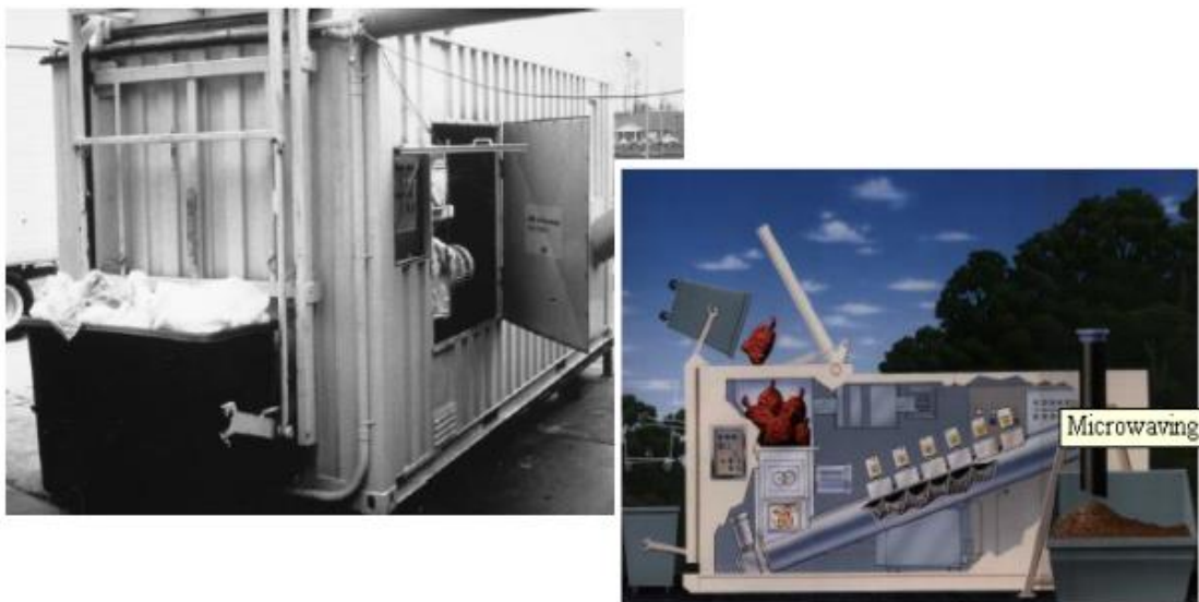
Σχήμα 15. Μονάδα αποστείρωσης αποβλήτων με τη μέθοδο των μικροκυμάτων (Αραβώσης Κ., 2008).
