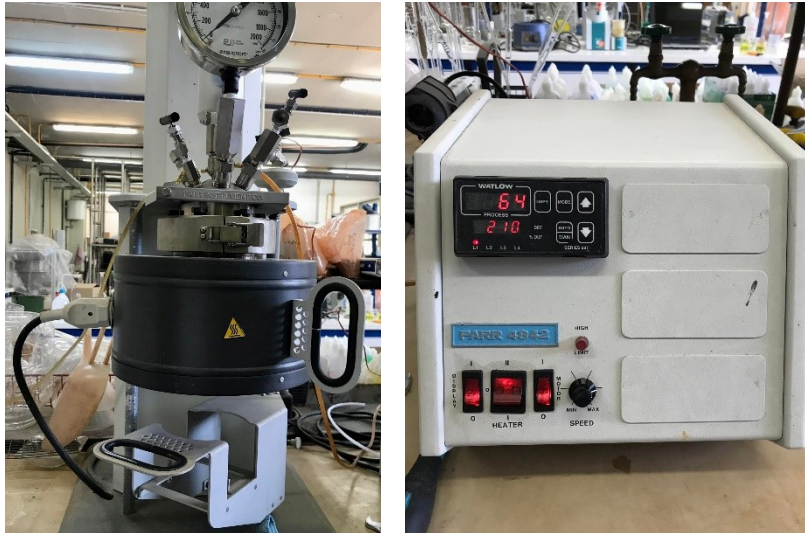
Εικόνα 8. Το αυτόκλειστο με το θερμαντικό μανδύα και την μονάδα ελέγχου της θερμοκρασίας και της ανάδευσης
