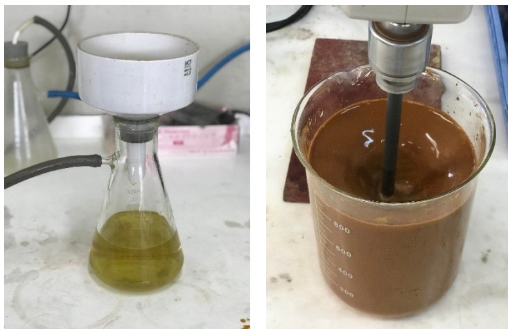
Εικόνα 9. Διήθηση του πολφού και έκπλυση του στερεού υπολείμματος με επαναπολοποίηση σε απιονισμένο νερό υπό ανάδευση
