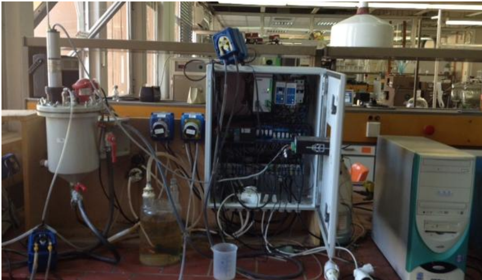
Εικόνα 2.1. Πειραματική διάταξη αναερόβιας χώνευσης στο εργαστήριο Χημικής και Οργανικής τεχνολογίας.
