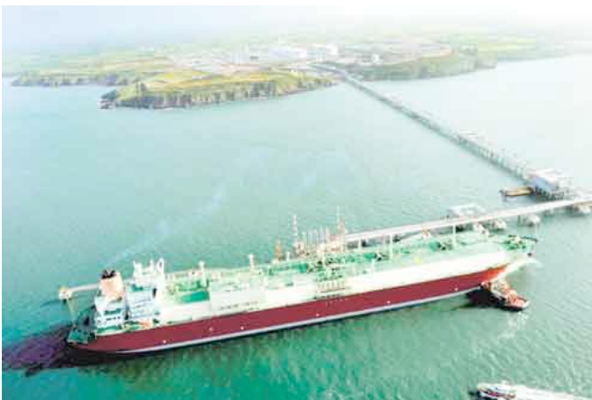
Mozah, το μεγαλύτερο δεξαμενόπλοιο ΥΦΑ τύπου Q-MAX σχεδιασμού μεμβράνης με χωρητικότητα 266.000 κυβ. μέτρα
