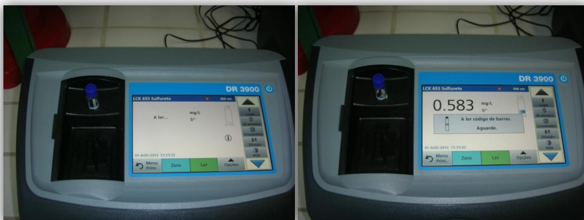
Figura 12: Espectrofotómetro utilizado para a determinação de fenóis.
