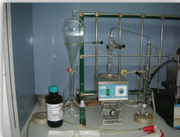
Figura 13: Determinação de O&G. À esquerda ampola de separação a verter a parte aquosa para o balão volumétrico, à direita sistema de destilação a recuperar o solvente contido no balão juntamente com o resíduo de O&G.
