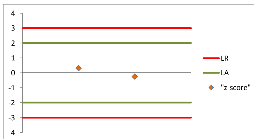
Figura 17: Representação gráfica do resultado do ensaio interlaboratorial. LR (Limite de Rejeição); LA (Limite de Aviso); “z-score” (resultados obtidos).
