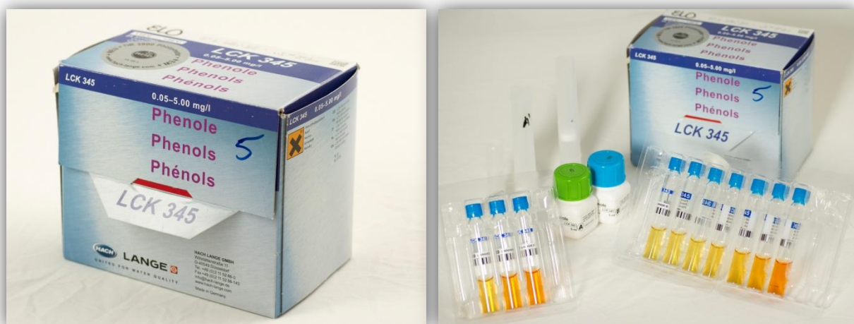
Figura 11: Micro Teste LCK 345: caixa à esquerda e kit completo à direita (as células apresentadas já incluem as amostras, neste caso os padrões, o que explica a gradação de cores visíveis nos tubos/células. Quando ainda não estão preenchidas com as amostras, as células apresentam reagentes de cor amarela).
