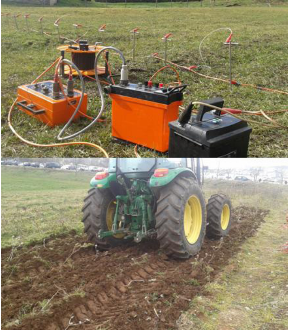
Estudio con tomografía de resistividad eléctrica del efecto del tráfico de maquinaria en un suelo agrícola
