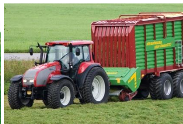
Semi-reboque auto-carregador de forragem
