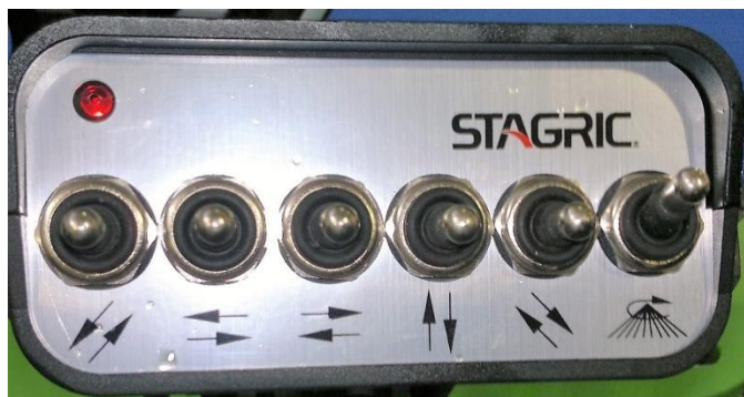
Comando do bloco de válvulas (electroválvulas) da máquina de encordoar vides
