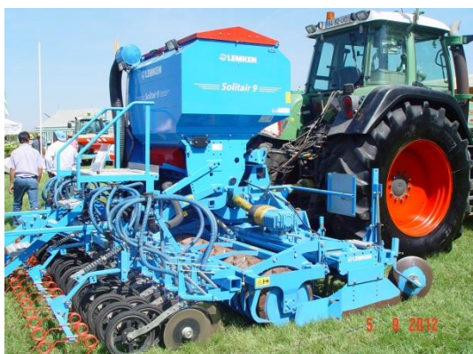
Semeador com distribuição de semente em corrente de ar
