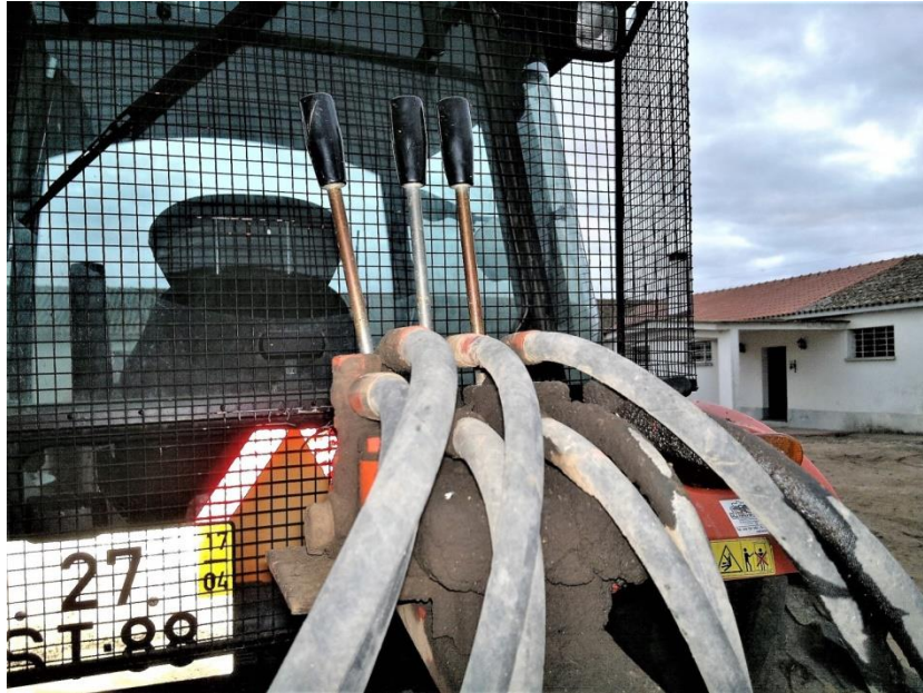
Bloco com 3 válvulas direccionais e respectivas alavancas de comando
