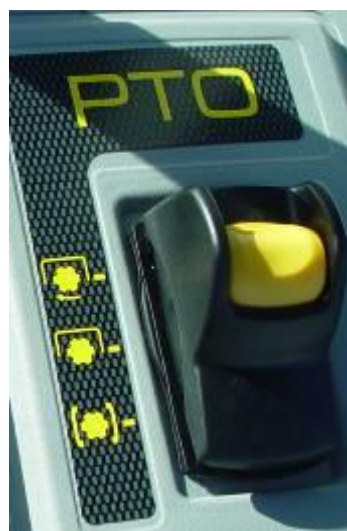
Comando eléctrico hidráulico da embraiagem da tdf
