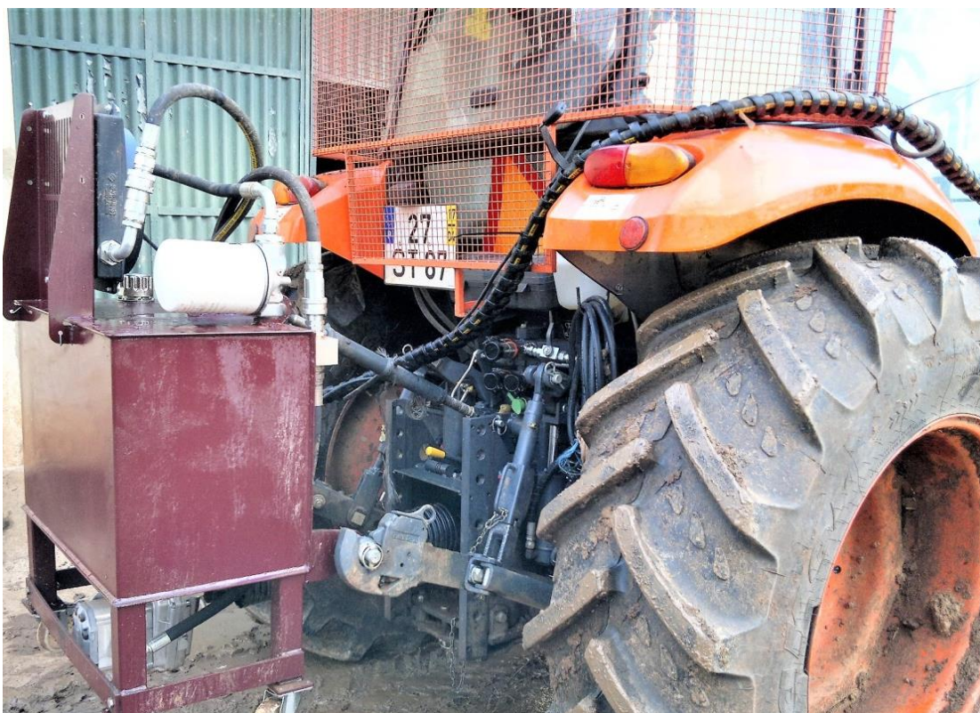
Ligação ao tractor da estação hidráulica equipada com depósito de óleo, bomba, filtro e arrefecedor de óleo. A bomba é actuada pela tdf via veio de Cardan
