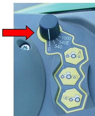
Comando eléctrico hidráulico da caixa de velocidades da tdf
