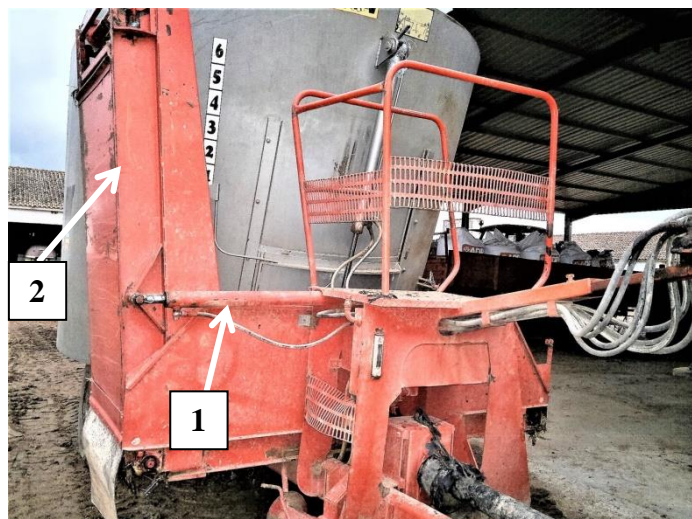
CHDE (1) para colocação na posição de trabalho ou de transporte tapete transportador de distribuição (2)
