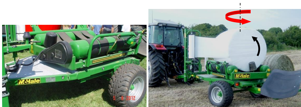
Mesa rotativa em torno de dois eixos
