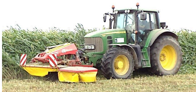
Tractor com gadanheira de discos ( disc mower ). Visita de estudo de tractores e Equipamentos Automotrizes 2015
