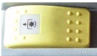
Comando eléctrico hidráulico da embraiagem da tdf
