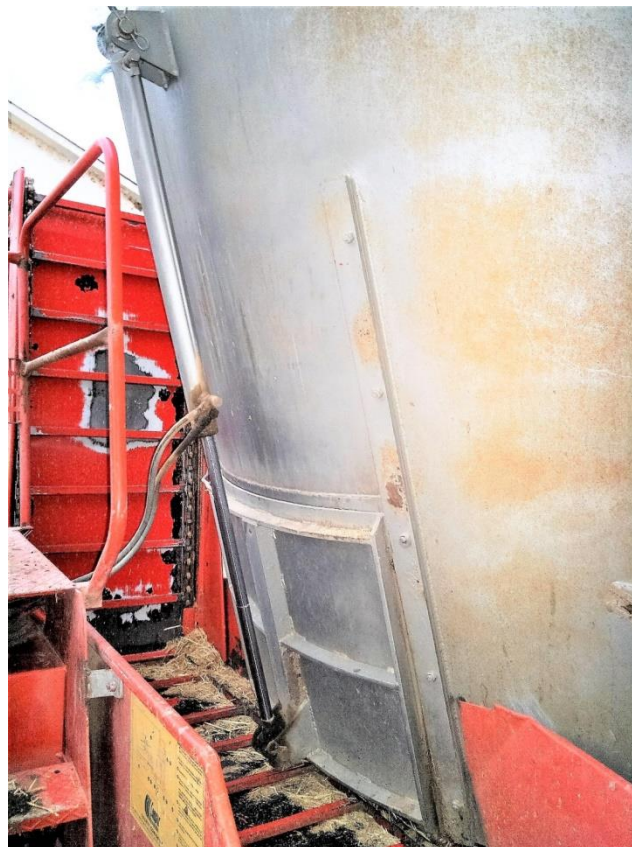
CHDE para deslizamento da porta da janela de distribuição
