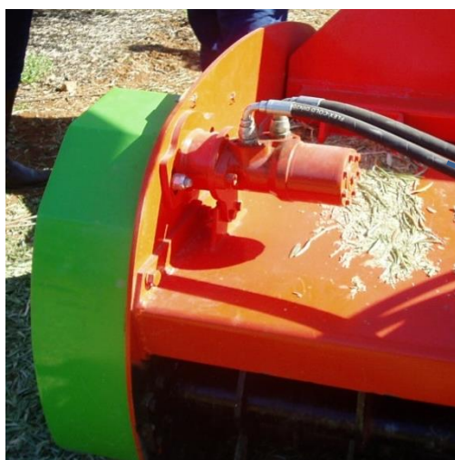
Ligação de um motor hidráulico ao SESH
