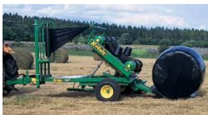
Rebatimento da mesa rotativa para evacuar o fardo
