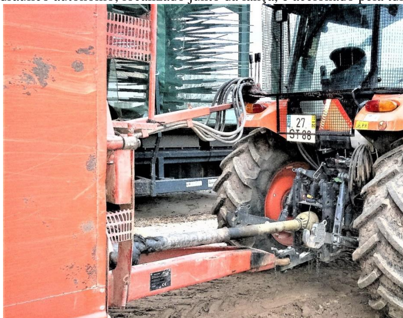
Ligação ao tractor do semi-reboque misturador e distribuidor de ração ( mix feeders ), através de veio de Cardan e lança ligada à barra-de-puxo
