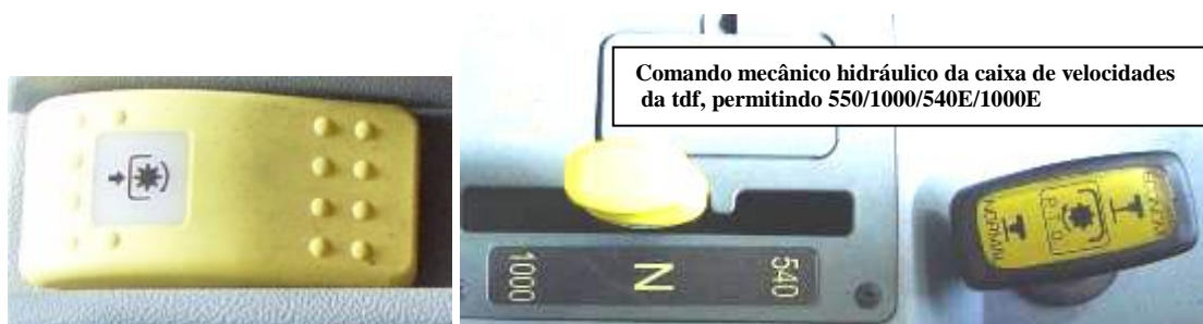
Comando eléctrico hidráulico da embraiagem da tdf
