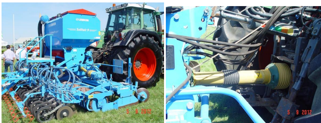
Semeador com distribuição de semente em corrente de ar Pormenor da ligação à tdf
