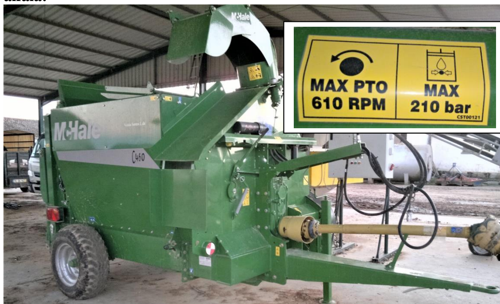
Destroçador de fardos, especificando limite para a rotação da tdf e pressão do SESH
