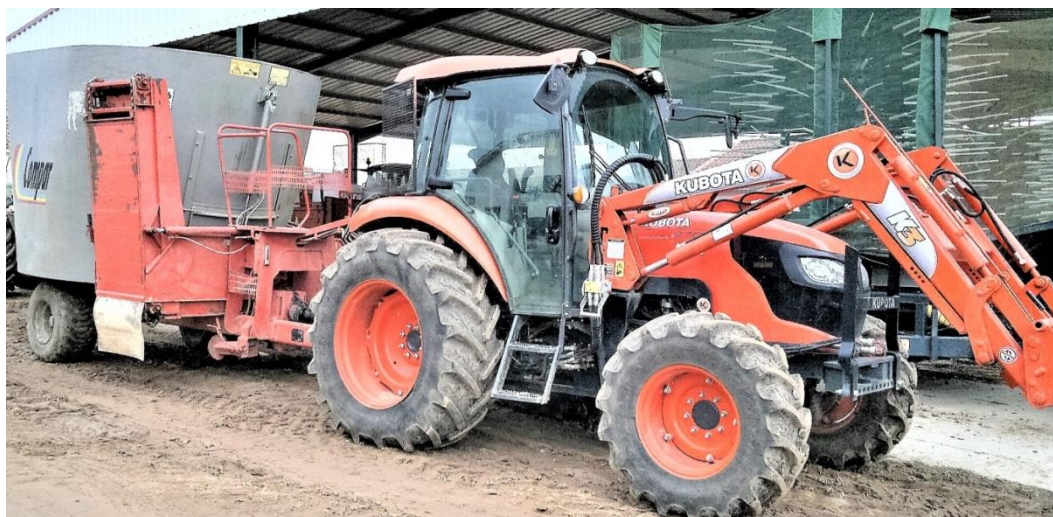
Semi-reboque misturador e distribuidor de ração ( mix feeders ) são exemplos frequentes de equipamentos com sistema hidráulico autónomo
