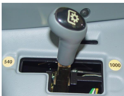
Comando da caixa de velocidades da tdf no tractor Valtra Valmet N82
