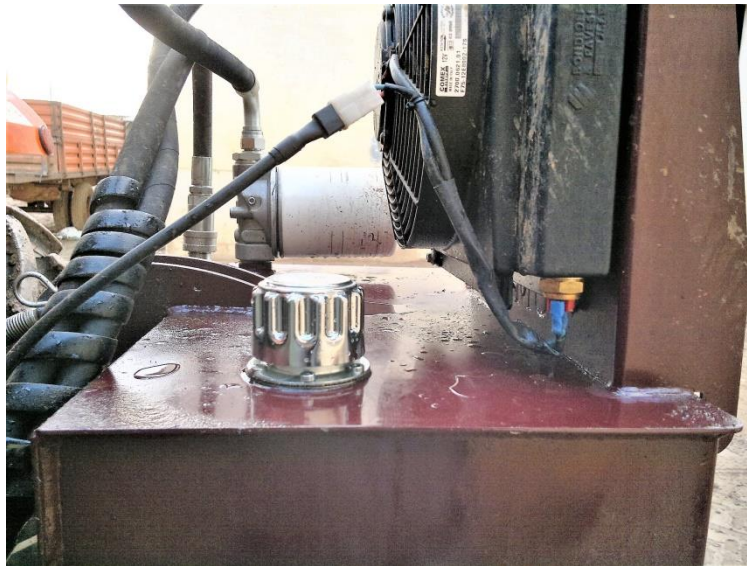
Reservatório de óleo com o respectivo bujão de enchimento
