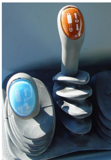
Tractor Vatra N82 – Válvula (vermelha) em detenção na posição de “recolha”
