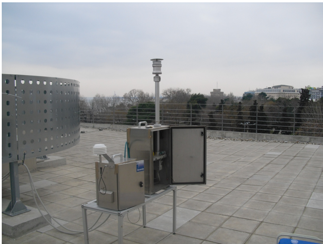
Εικόνα 22. Μέτρηση στο Δημαρχείο Θεσσαλονίκης με αντλία ροής small filter device PNS3.1-15
