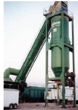
Imagen 2.55: Almacenamiento de Sólidos.
