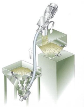
Imagen 2.24: Funcionamiento de un transportador de tornillo.
