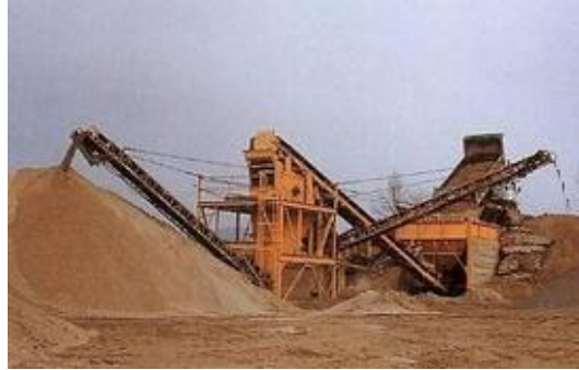
Imagen 2.22: Transportador de banda en la industria extractiva.
