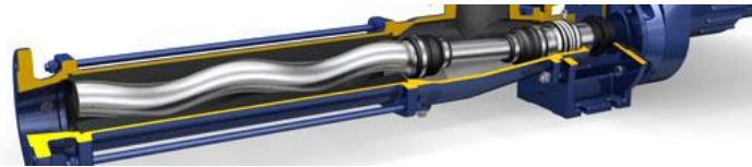
Imagen 2.2: Bomba de tolva abierta (Principio de funcionamiento).
