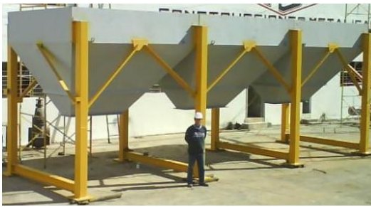
Imagen 2.51: Tolvas de Compuerta.
