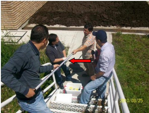
Fotografía 1.2: Tubo tipo probeta para muestreo de lodos.
