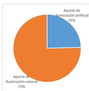
Figura 2.46: Ejemplo del porcentajes que aportarían las fuentes de luz artificial y natural para cumplir la recomendación de la norma española
