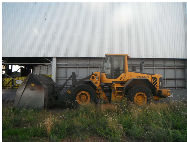
Obr. 33 Nakladač využívaný pro manipulaci a konečné umístění biomasy
