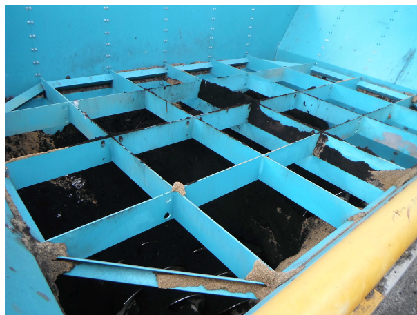
Obr. 17 Podzemní kontejner pro dodatkové palivo (palmové oříšky, uhelné kaly, pivovarské mláto) k hnědému uhlí do kotle K6
