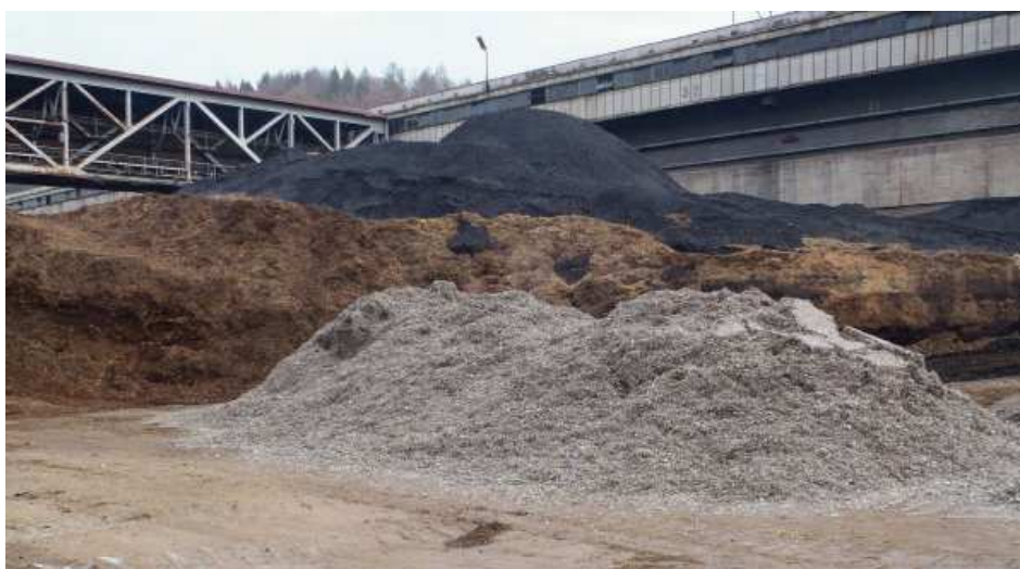
Obr. 36 Tři druhy paliva pro elektrárnu (TAP, biomasa, hnědé uhlí) [21]
