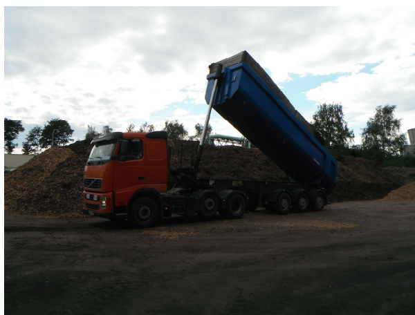
Obr. 29 Nákladní automobil externí společnosti – vykládka dřevní štěpky
