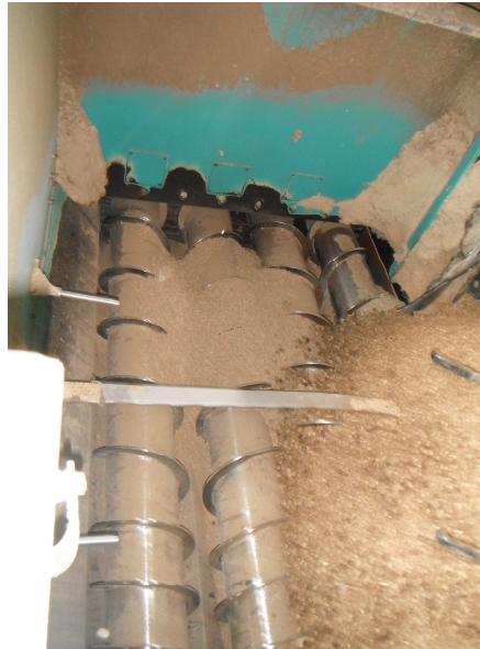
Obr. 30 Přeprava peletek šnekovými dopravníky
