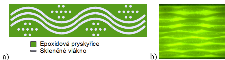
Obr. 3-3: a) Řez strukturou FR-4, b) Fotka z fluorescenčního mikroskopu
