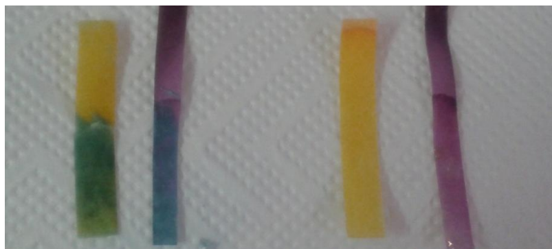
Obr. 24 Měření pH univerzálním lakmusovým papírkem a indikátorem z červeného zelí u tuhého mýdla (vlevo) a tekutého mýdla (vpravo).
