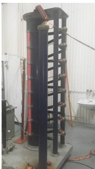
Obrázek II. Impulzní generátor HAEFELY a jeden stupeň jeho simulačního schématu
