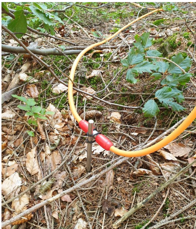
Obrázek 18: Uzemněná elektroda s pryžovou gumičkou. Vlastní foto autorky, 2019.
