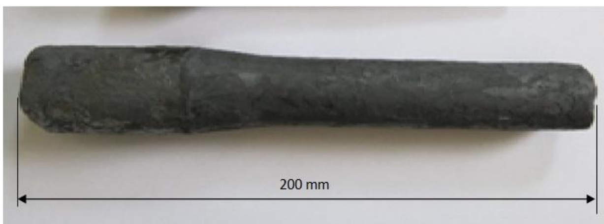
Obr. 36: Vykováný polotovar pro sonotrodu.
