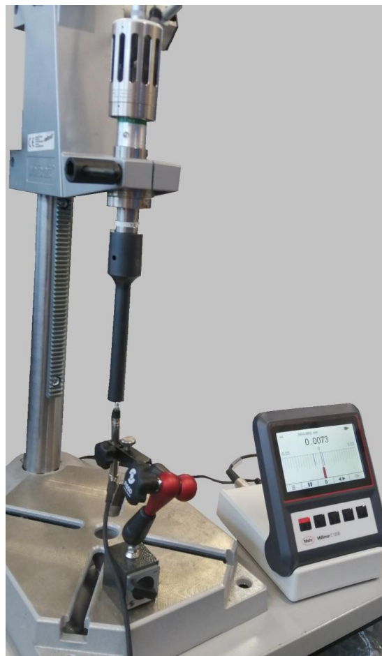
Obr. 67: Měření podélného posunutí
