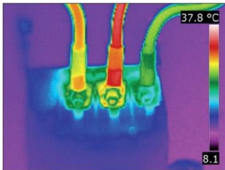
Obr. 7.13: Nestejná teplota na svorkovnici motoru
