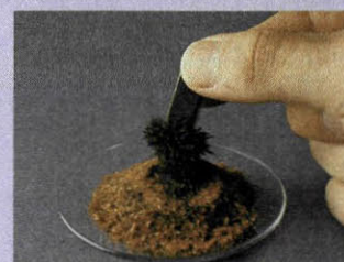
Διαχωρισμός ριζισμάτων σιδήρου από χώμα, σε ετερογενές μίγμα, με τη βοήθεια μαγνήτη.
