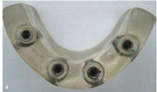
Figura 4 - Modelo fotoelástico pronto para o ensaio.
