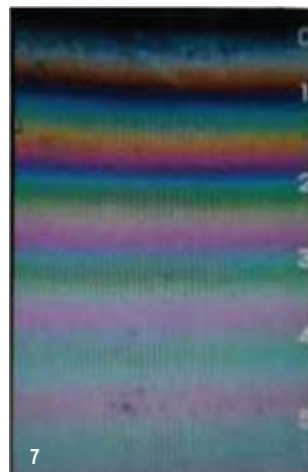
Figura 7 - Padrão fotoelástico indicando número de ordem de franjas isocromáticas inteiras. Fonte: (Torres 27 , 2005).
