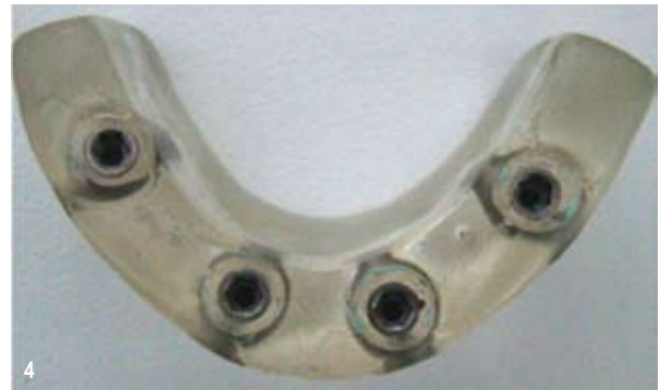
Figura 4 - Modelo fotoelástico pronto para o ensaio.
