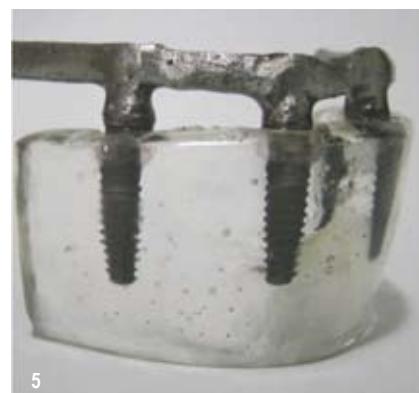
Figura 5 - Barra metálica de níquel-cromo posicionada no modelo padrão.
