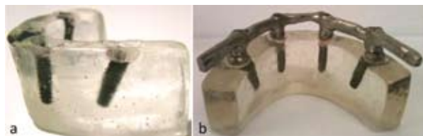
Figura 6a e b - Modelo fotoelástico com os implantes distais inclinados (a) e a barra instalada no modelo fotoelástico (b).
