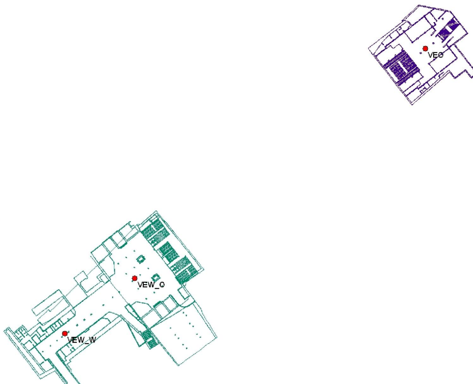
Abb. 1.29: Position der Schwerpunkte, der als Volumenquelle definierten Freisetzungsorte in den Verteilerebenen West (links) und Ost (rechts).
