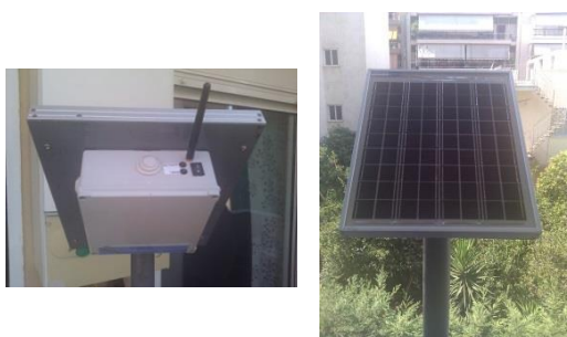
Εικόνα 5. Εμπρός και πίσω όψη του ασύρματος κόμβου αισθητήρων για χρήση στο περιβάλλον της γεωργίας.
