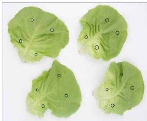
Εικόνα 1. Παρουσίαση σημείων μέτρησης του χρώματος με το χρωματόμετρο Minolta CR-300.
