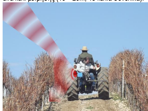
Εικόνα 1. Σάρωση των κληματίδων με το laser scanner LMS200.
