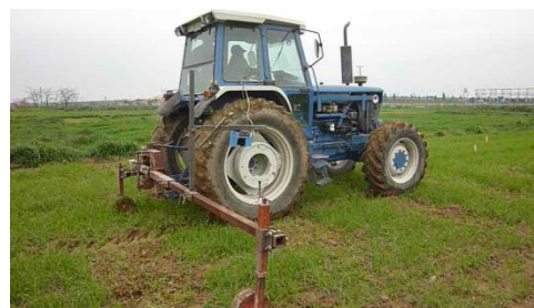
Εικόνα 1. Η πειραματική διάταξη με το σαρωτή λέιζερ σε γωνία μέτρησης 0°.
