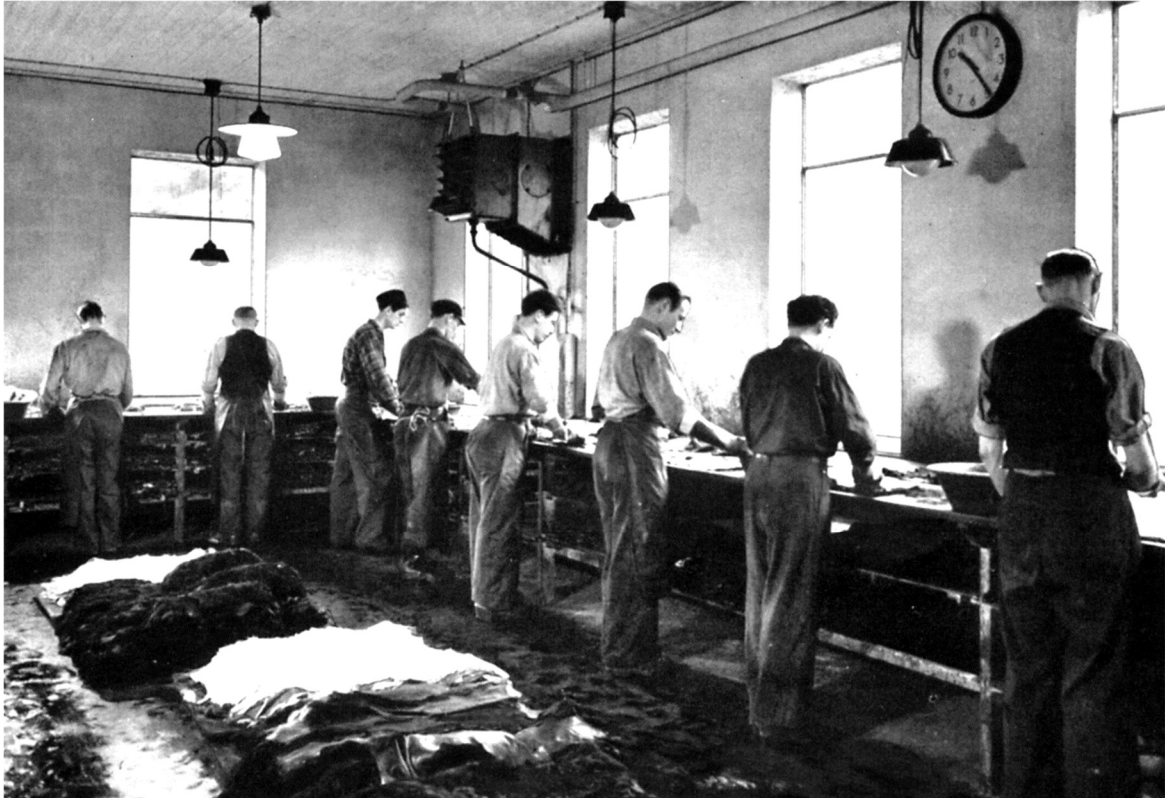
En stor del av skinnen som beretts, förädlas ytterligare genom olika färgnings processer. På bilden ser man den pågående spetsstrykningen, d.v.s. hur skinnens hårsidor bestryks med färg en eller flera gånger innan de får gå i färgbadet
