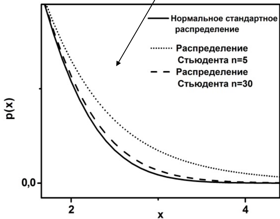
Рис 5.1. Распределение Стьюдента для различных значений n и нормальное стандартное распределение (а), увеличенный выделенный участок графика (б).
