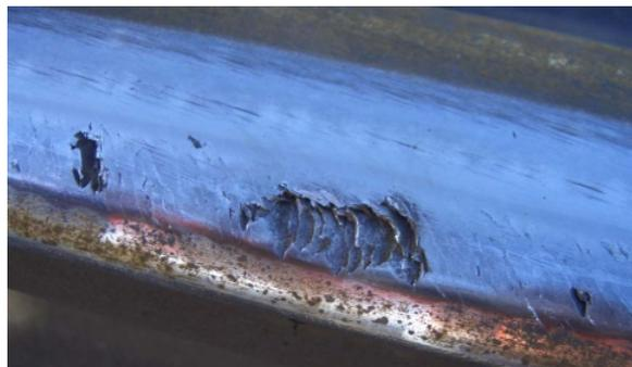
Abbildung 1.1: Verschleiß im Rad-Schiene-System [Dul].
