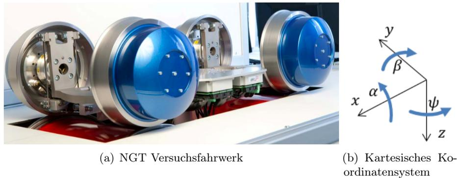
**Abbildung 3.3:** NGT Versuchsfahrwerk mit einem kartesischen Koordinatensystem [Val10]
