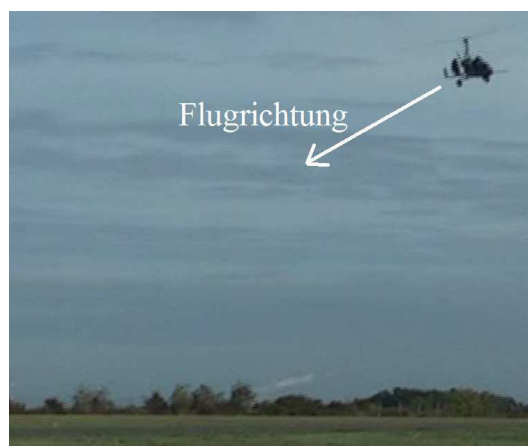
Abbildung 3.1: Ansicht eines Tragschraubers im Seitengleitflug mit Nase links kurz vor dem Ausrichten und Abfangen
