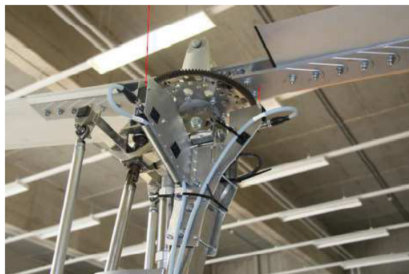
Abbildung 4.4: Anbringung der Lasersensoren am Rotormast [16]
