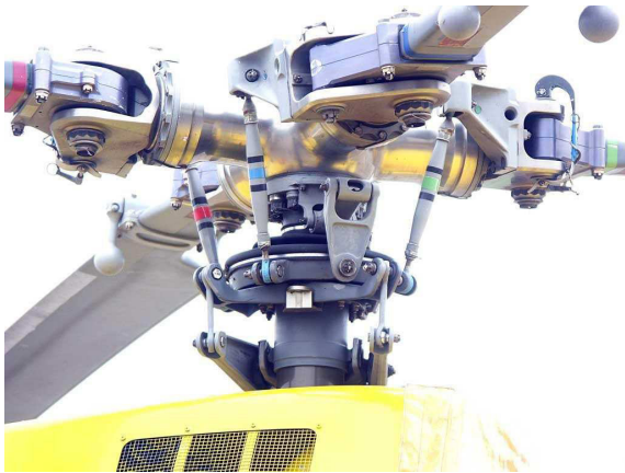
Abbildung 2.2: Rotorkopf des Helikopter Bo105 mit Taumelscheibe
