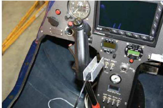
Abbildung 4.3: Inklinometer am Steuerknüppel [16]
