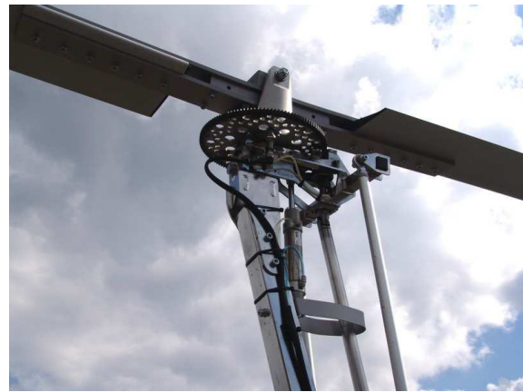
Abbildung 2.3: kippbarer Rotorkopf des Gyrokopter MT0sport
