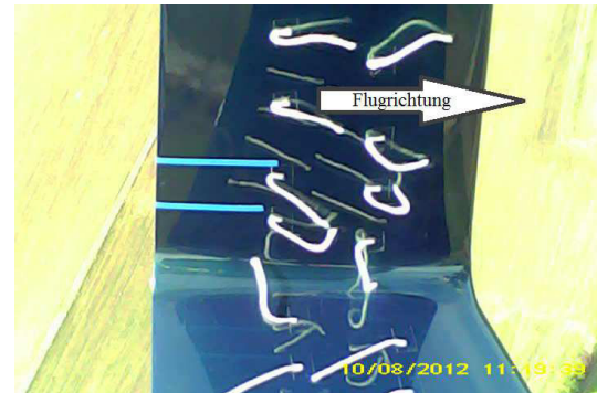
Abbildung 5.19: Linkes Leitwerk im Seitengleitflug mit Nase rechts
