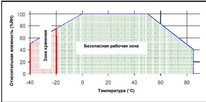
Выход за безопасный рабочий диапазон приведёт к снижению точности измерений. Чтобы обеспечить долговременную стабильность функционирования логгера, его корпус не следует подвергать воздействию сильных кислотных или щелочных сред. Пыль на поверхности фильтра не повлияет на производительность регистратора, но увеличит время отклика.
