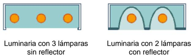
El rendimiento de una luminaria se ve afectado cuando una parte importante de la luz emitida es absorbida por el plafón, el reflector o el difusor.
