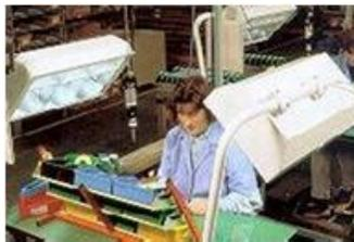
Se instalan en los pasillos alrededor de los puestos de trabajo con el fin de que la luz llegue lateralmente, sin provocar sombras ni deslumbramientos.
