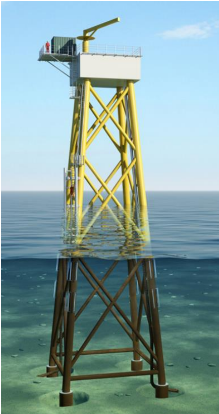
Figur 10-6. Principskitse af jacket-fundament (Energinet.dk, 2015).
