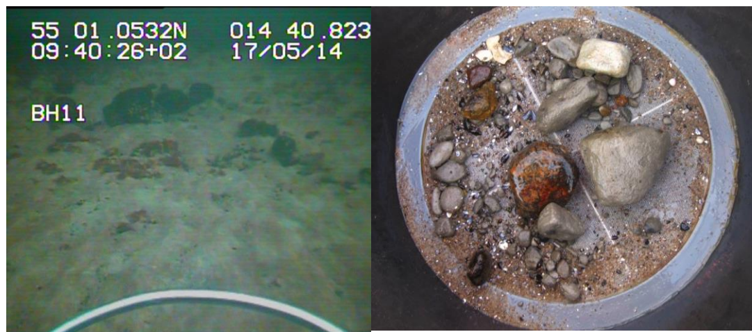
Figur 12-12. Fotos af to forskellige havbundstyper fundet i undersøgelsesområdet. Sedimentet består af sand og sten i forskellige størrelser (MariLim, 2015).
