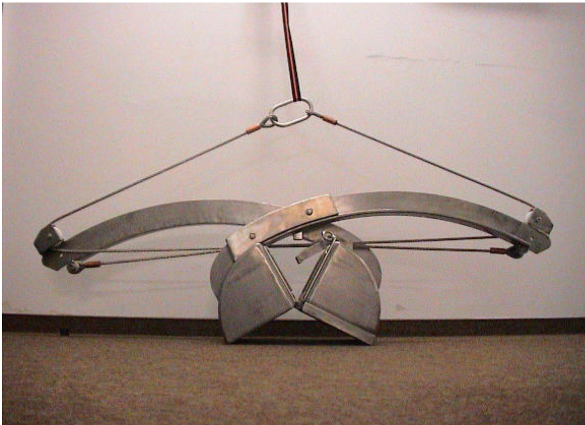
Abb. 3.2 van Veen-Backengreifer, Foto: A. SCHRÖDER AWI Bremerhaven
