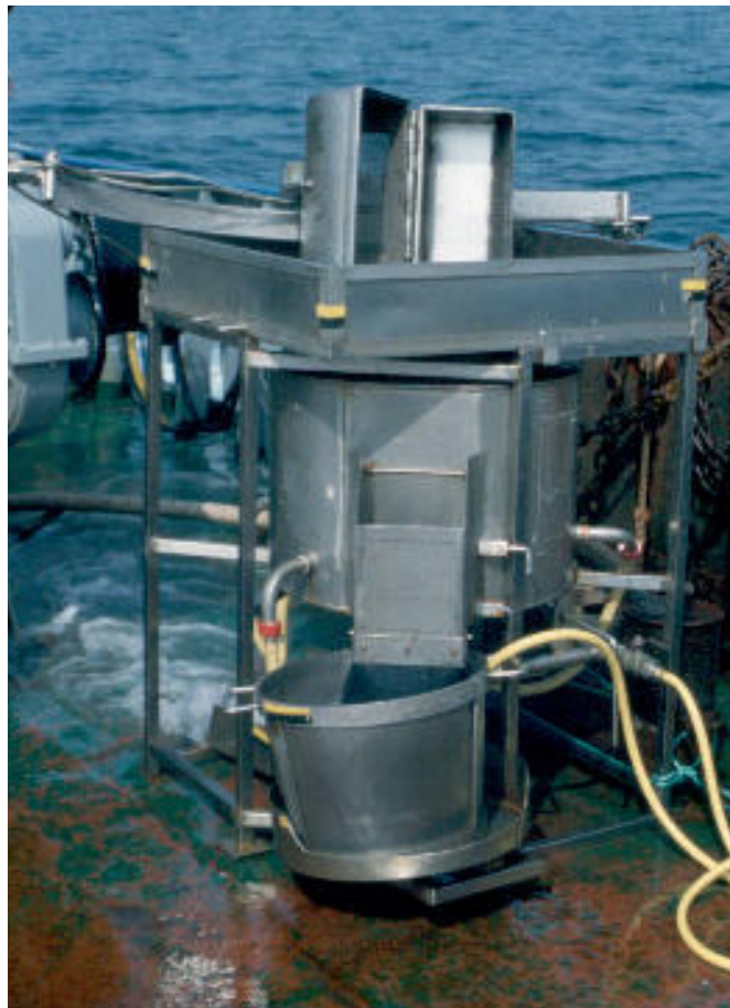
Abb. 3.3 van Veen-Backengreifer auf Sedimentspülmaschine, Foto: A. SCHRÖDER AWI Bremerhaven.
