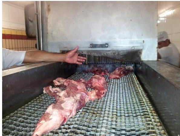
Figura 5. Mantas bovinas passando pelo processo de cura (nitrito e nitrato), através de injetoras automáticas.
