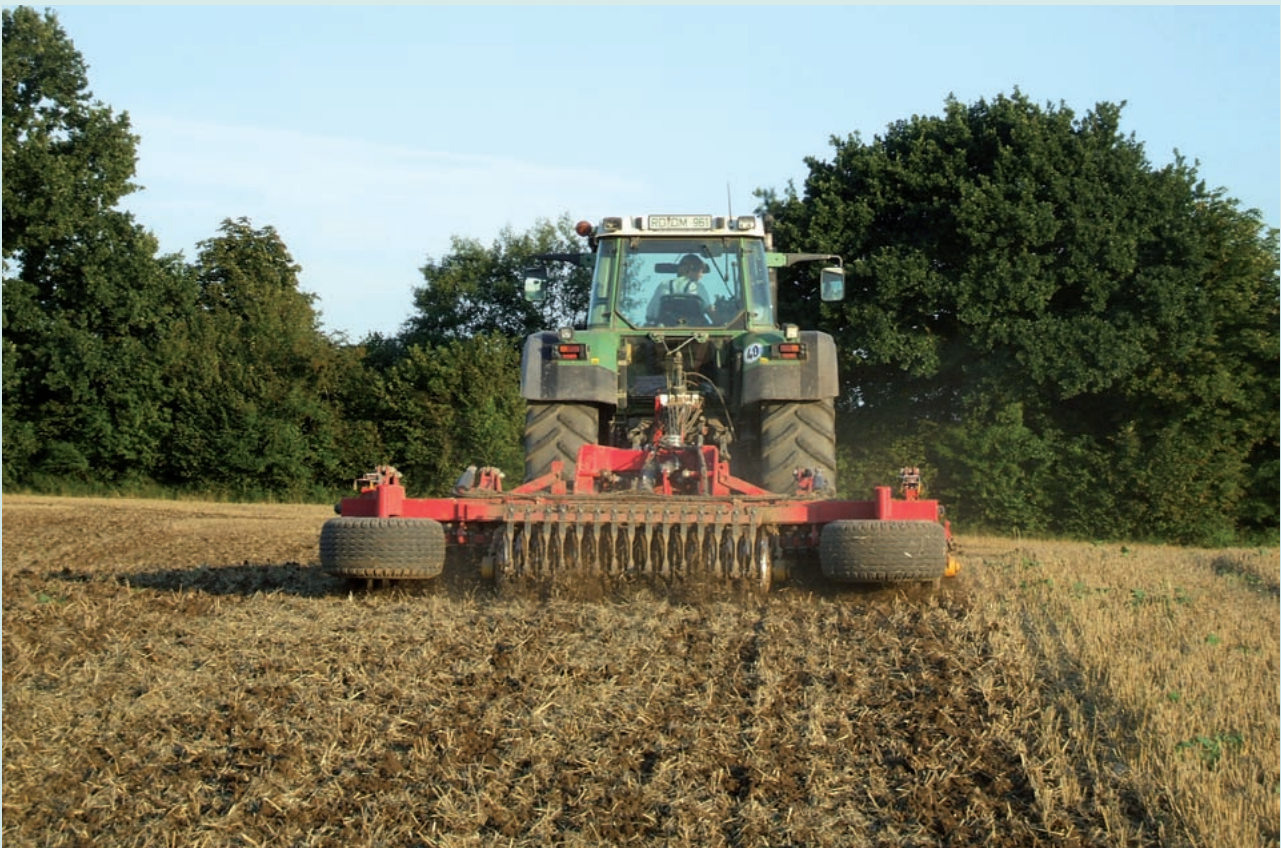
Δισκοσβάρα σε λειτουργία σε επιφανειακή κατεργασία του εδάφους (Γερμανία) (Πηγή: Stephan Hubertus Gay)
