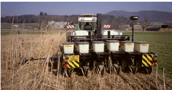
Απ' ευθείας σπαρτική μηχανή σε λειτουργία (Πηγή: Jana Erperlein, Gesellschaft für konservierende Bodenbearbeitung e.V., Γερμανία)
