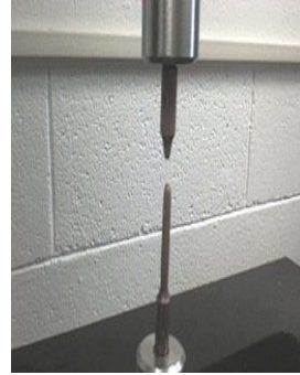
Probeta de cobre fractura en el ensayo de tensión.
