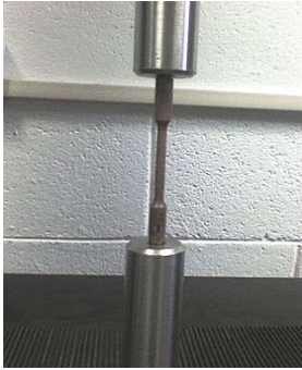
Probeta de cobre antes del ensayo de tensión por computadora.
