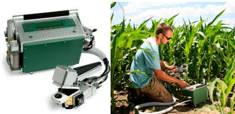
Fig 7: Sistema para la medición del intercambio de gases fotosintéticos. IRGA
