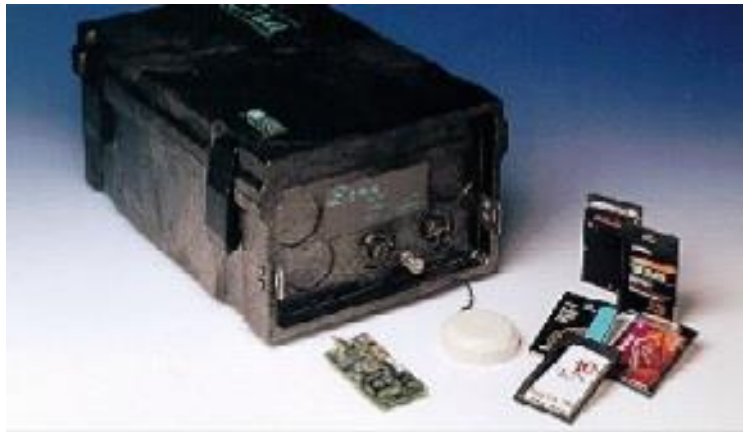
Figura 4.1 - Unidade triaxial de medição de acelerações (Monteiro e Bento, 2013a)
